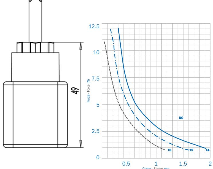
Curve rilevate in funzione degli attuatori utilizzati con tensione nominale ridotta del 10%. I valori riportati sono indicativi.
